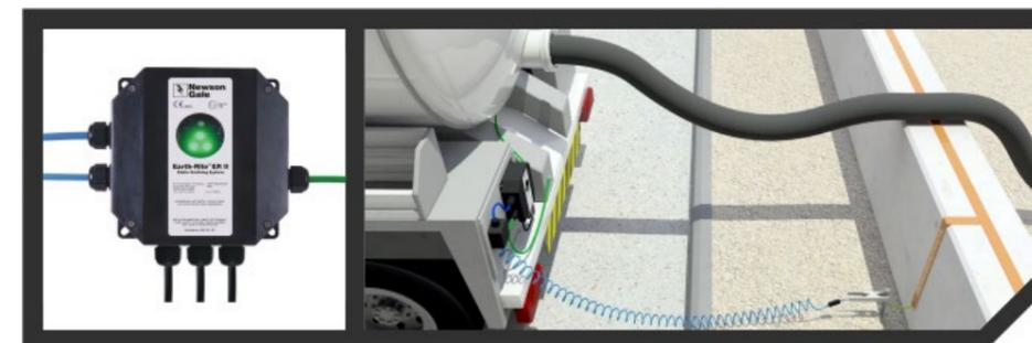
Il sistema Earth-Rite® MGV (Mobile Ground Verification) è una tecnologia esclusiva e brevettata, progettata per fornire la conferma automatica del collegamento a terra elettrostatico positivo degli automezzi utilizzati per il carico e il trasporto di prodotti infiammabili/combustibili.
